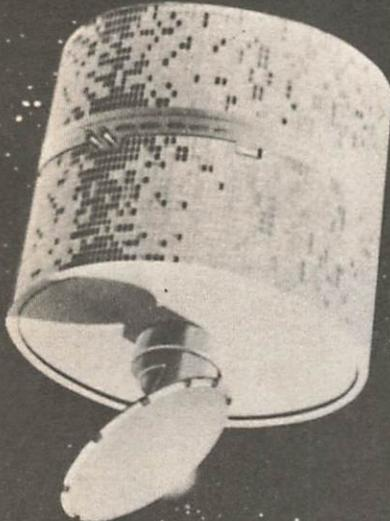
なる。これでニューギニア島上空の静止衛星としては7月に打ち上げられた「ひまわり」に続いてわが国3番目のものとなる。衛星本体は直径1・28m、高さ2・2mの円筒形で、通信容量は電話で4000回線、テレビだと8チャンネルである。実験は衛星を通信の宇宙中継基地として、茨城県鹿島の電波研鹿島支所から電波を送り、衛星が反射した電波を横須賀市の電電公社通信研究所でキャッチする。またパラボラを自動車に積んだ移動局や離れ小島の地上局などと電波研鹿島支所との通信実験も計画されている。
