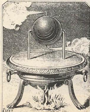
水蒸気を吹き出させて球を回転させる装置をヘロンは1900年も昔に考案していた
